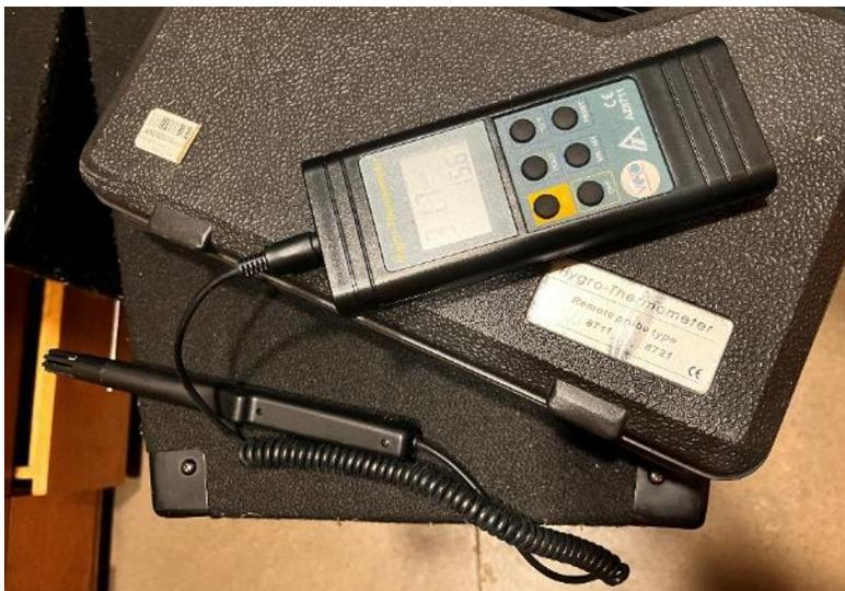
*Figura 122 – fotografía de instrumento de medición de temperatura y humedad relativas – 7 de julio*
